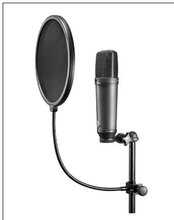
Bei Nahbesprechung von Mikrofonen ist häufig eine unangenehme Übersteuerung zu hören, das sogenannte Popgeräusch. Dies wird vor allem durch Plosivlaute wie „p“, „t“ und „k“ hervorgerufen. Bei diesen können mühelos Spitzenpegel von 135 dB SPL bei normaler Stimmlage erzeugt werden.
